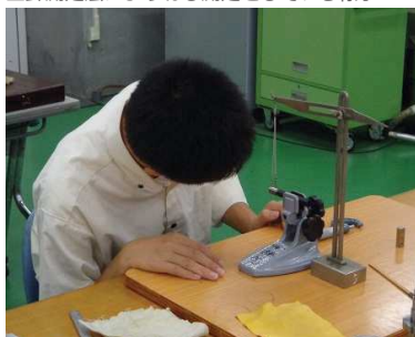
微妙に揺れる三針ゲージをねじ部3カ所に当ててマイクロメータで測定している
