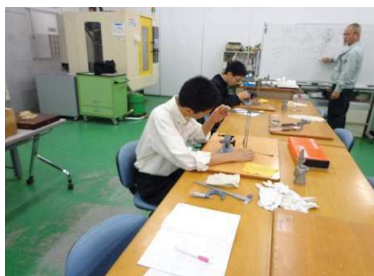
三針測定法によりねじ測定をしている様子
