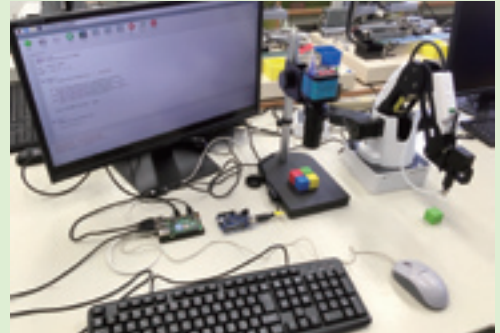
カメラを使い、良品・不良品をAIで判断し、ロボットハンドが分別する新技術
